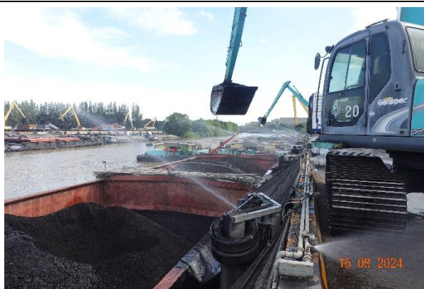
รูปที่ 2-23 การฉีดพรมน้ำบริเวณกองถ่านหินบริเวณพื้นที่หน้าท่า และหลังท่า
